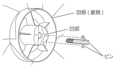
羽根取り付け時は、羽根の凹部とモーター軸のピンを合わせて取り付けてください。
