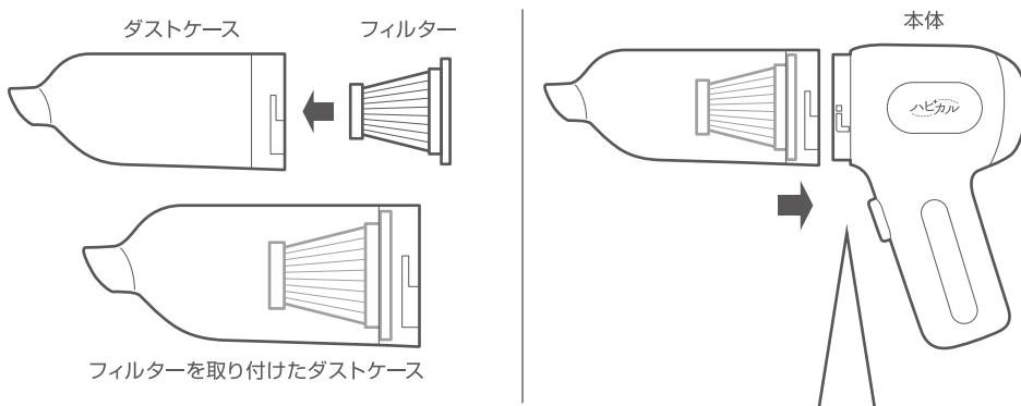
①ダストケースの 部分を本体の 部分に合わせて取り付けます。
