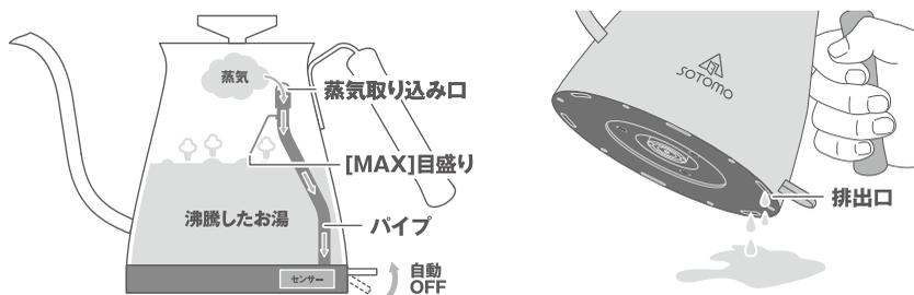
本製品は、蒸気取り込み口から蒸気がパイプを通ることで沸騰を感知し、自動でスイッチがオフになるしくみです。
