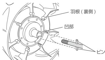
羽根取付け時は、羽根の凹部とモーター軸のピンを合わせて取り付けてください。
