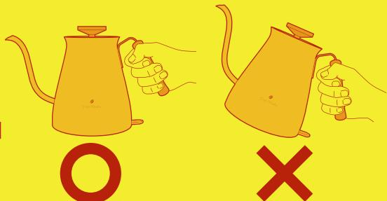
[MAX]目盛りを超えた量の水を入れて使用したり、本体を手前に傾けたりすると蒸気取り込み口から大量の水(熱湯)が入り、故障や、排出口からこぼれた熱湯でやけどをする恐れがあります。水位は必ず[MAX]目盛り以下で使用し、本体を移動するときは水平を保った状態で製品をお持ちください。
