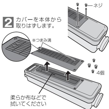
**3** 本体のファン(羽根)付近に付着したホコリなどを取り除き、取りはずした逆の順に、もとのように取り付けます。
