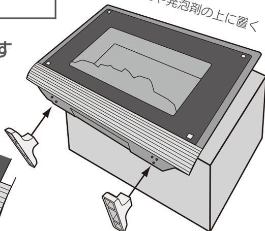
本体を安定した箱の上などに置いて、底面にスタンド取付け穴、取付け位置を確認します。
